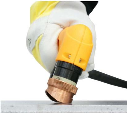
Abb. 11.: Schneiden mit Fasenkronen
