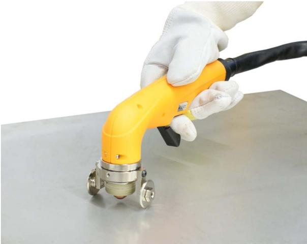
**Abb. 12.: Schneiden mit Räderwagen**
