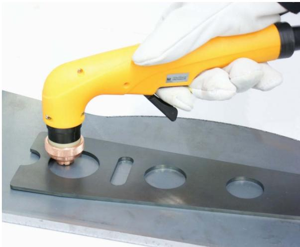
**Abb. 10.: Schneiden mit Aufsatzkappe**
