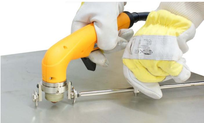
**Abb. 13.: Schneiden mit Kreisschneideinrichtung**
