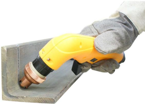
**Abb. 15.: Schneiden mit langen Verschleißteilen**
