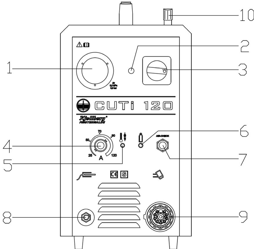
**Abb. 4.: Bedien- und Anzeigeelemente CUTi 120 (Frontwand)**
