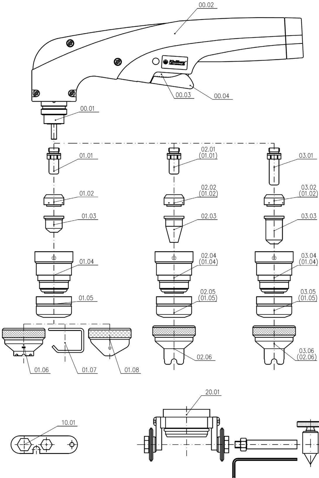
Abb. 17.: Verschleißteile des Plasma-Handbrenners KjellCut 120
