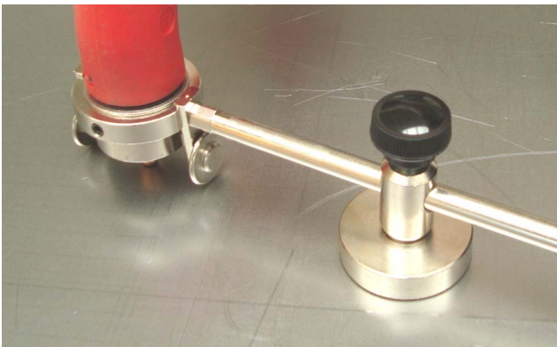
Abb. 9.: Schneiden mit Kreisschneideinrichtung
