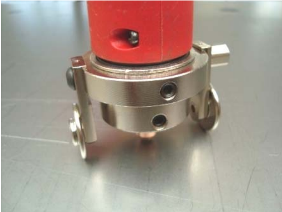
Abb. 8.: Schneiden mit Räderwagen
