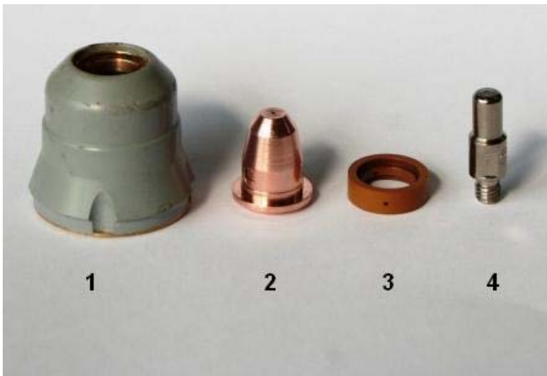
Abb. 12.: Verschleißteile des Plasma-Handbrenners
